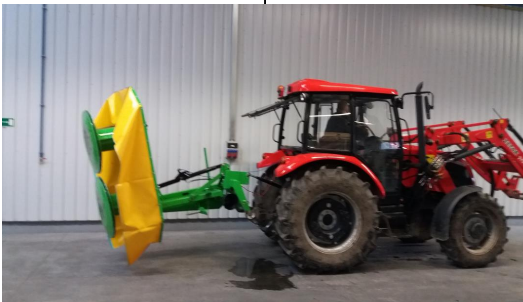
Fig. 5: Configurazione da trasporto delle falciatrici 185 M e 165 M nella versione con cilindro idraulico Proper transport position for 185 M and 165 M mowers in the hydraulic cylinder version
