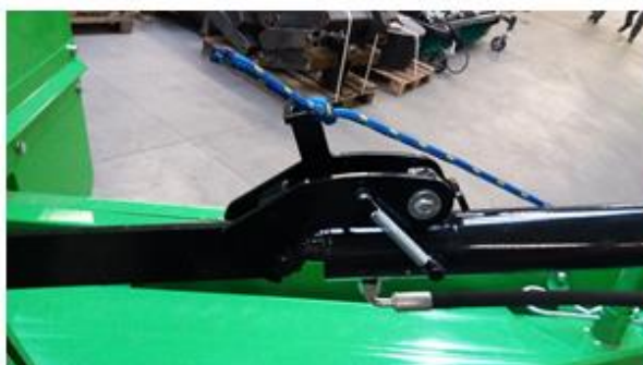
Fig. 6: Chiusura del cilindro A) chiuso – B) aperto Cylinder closure: A) closed, B) open
