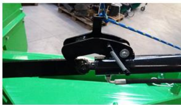
Fig. 6: Chiusura del cilindro A) chiuso – B) aperto Cylinder closure: A) closed, B) open
