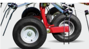
Ruote tandem sul modello trainato (G6-740 PTH). Ruedas tándem en el modelo arrastrado (G6-740 PTH).
