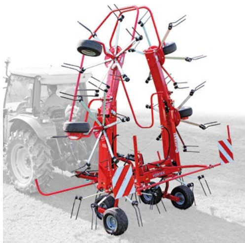
Versione trainata (modello G6-740 PTH) in posizione di trasporto Versión arrastrada (modelo G6-740 PTH) en posición de transporte.
